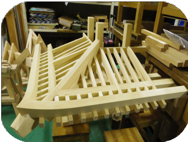
完成した二軒反り隅木。美しい青森ヒバを使って 仕上っている。試作品を杉材で一度作ってから制作した。
