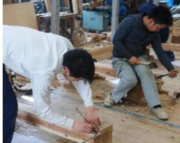
進級試験(実技)の様子。図面の読み方、サシガネの使い方、墨付け、刻み。学んだことの理解度が問われます。3月27日
