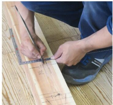
図面通りに正確に墨付けすることが高精度のものづくりの第一歩
