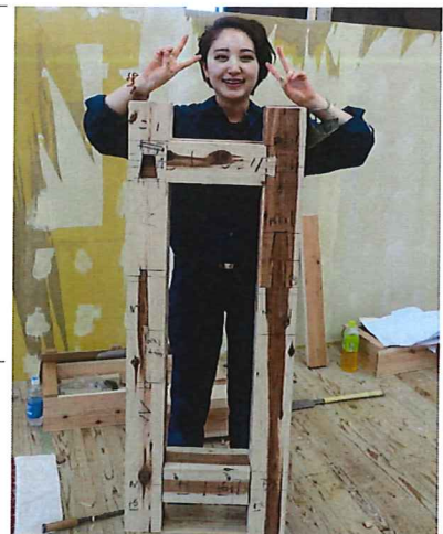
正確な墨付け、加工でないと図面通りの接合ができない継手・仕口の複合構造体「カレッジフレーム」完成!(6月25日)
