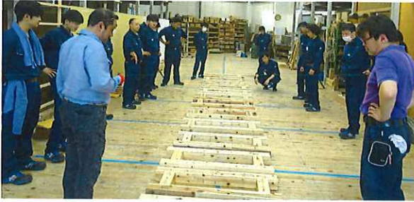
上写真：精度を高めるため金輪継手を調整中。 右写真：カレッジ・フレームの完成で互いの成長を確認する研修生たち(6月22日、江東実習場)
